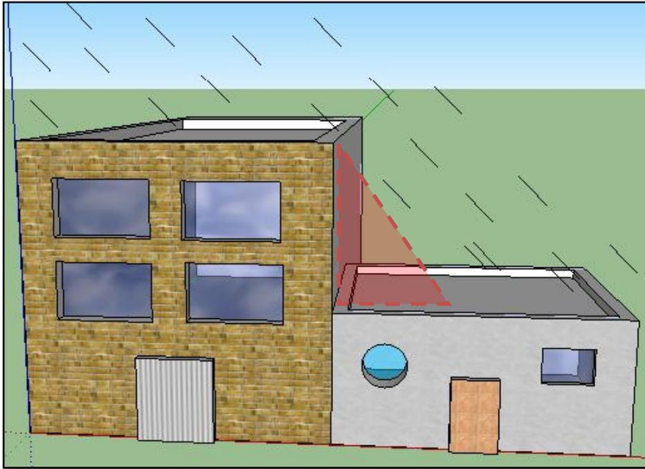
Figura 8 - Reducción del área de captación por efecto del viento
