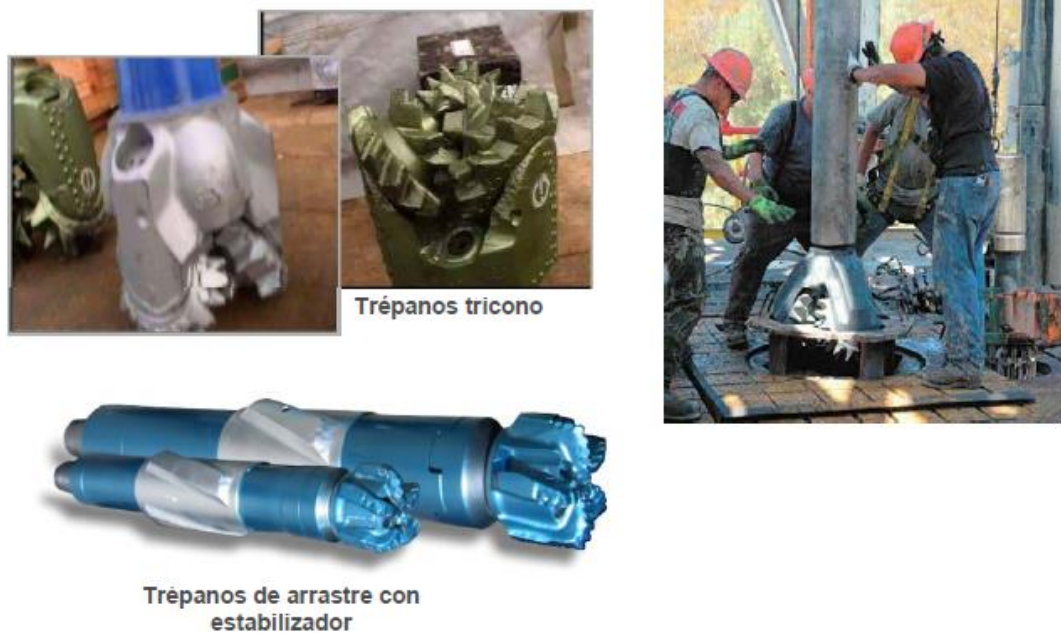
Ilustración 12. Trépanos utilizados en la perforación.
