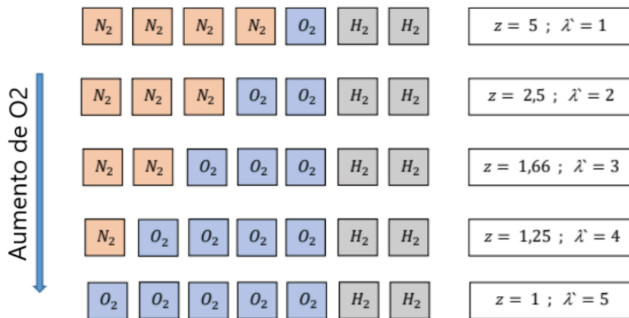
Figura 3.5. Proporciones de combustible y sustancia utilizados en CEARUN.
