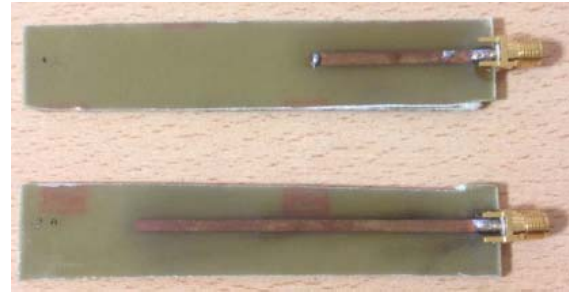
Fig. 1. Ejemplo de las líneas utilizadas para determinar el \epsilon_r de la placa (Línea de \lambda/4 en corto circuito y \lambda/2 en circuito abierto).
