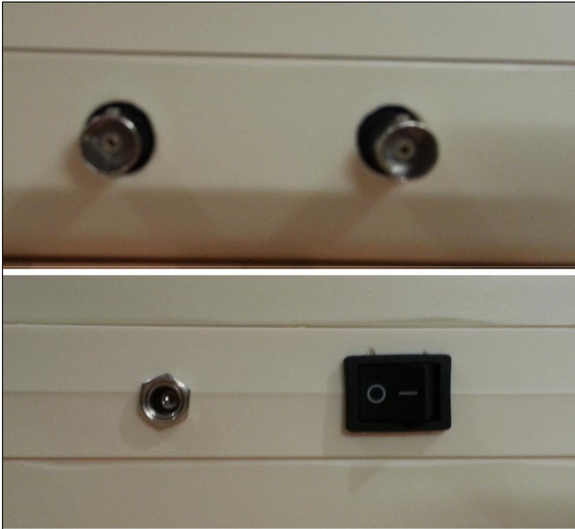
Fig. 7.8: Conectores BNC para entrada de las señales (arriba); conector para alimentación y botón de encendido (abajo)
