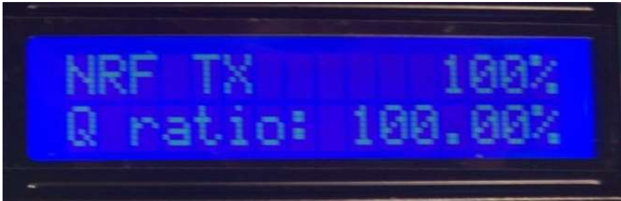
Ilustración 6: Medición calidad de enlace en modo Master.
