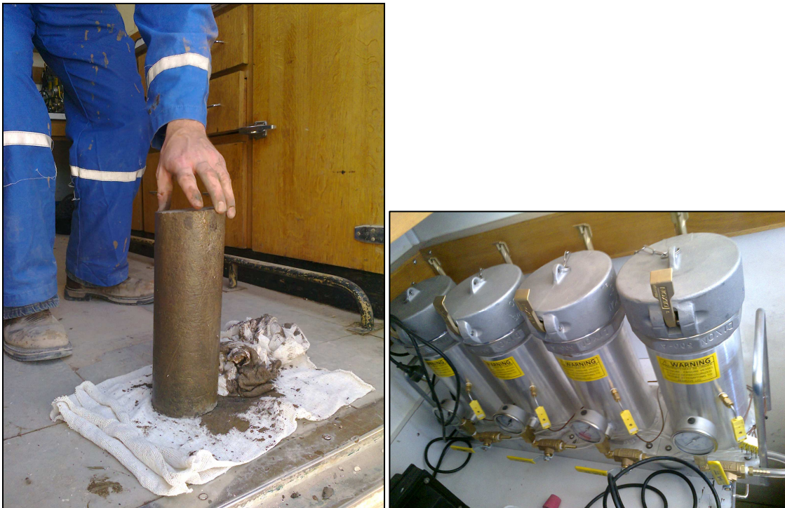
Figura 5. Izquierda: trozo de un pie de largo de una corona. Derecha: Canisters para la medición de gas adsorbido.
