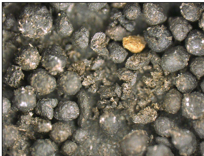
Figura 13. Presencia de crushing generado durante el ensayo de empotramiento.
