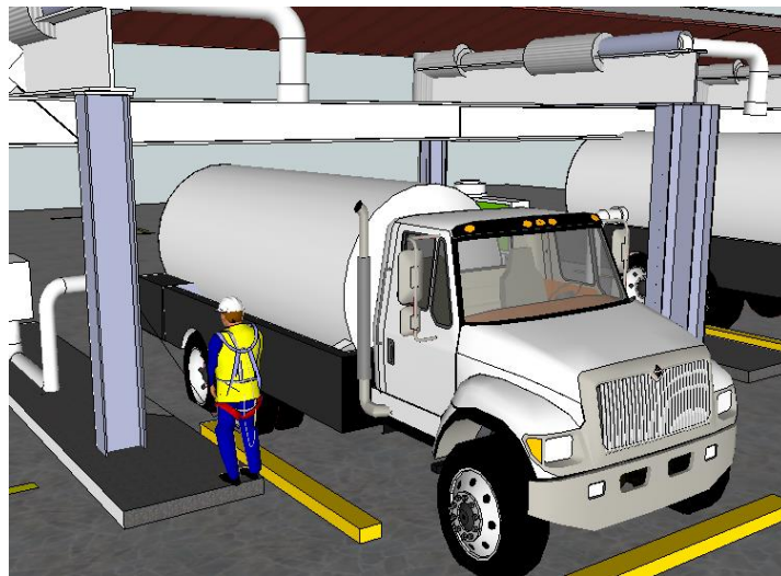
Figura 4.27 Operador desconecta cable a tierra
