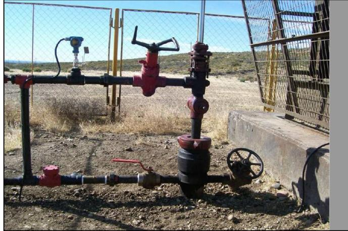
De igual modo, las señales provenientes de una batería donde el nivel de tanque es un limitante para la operación del pozo pueden ser variables alerta y parada. Adicionalmente se han desarrollado sensores para detectar pérdidas por empaquetaduras en el stuffing box (ver Figura 20). También son de características antiexplosivas como los de presión y permiten programar con antelación su intervención, así como la parada del pozo en caso de necesidad.
