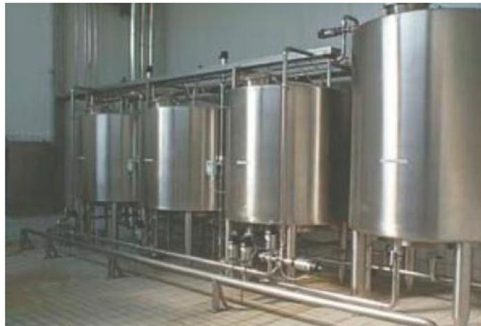
Figura 8.4 Tanques para limpieza CIP<sup>15</sup>
