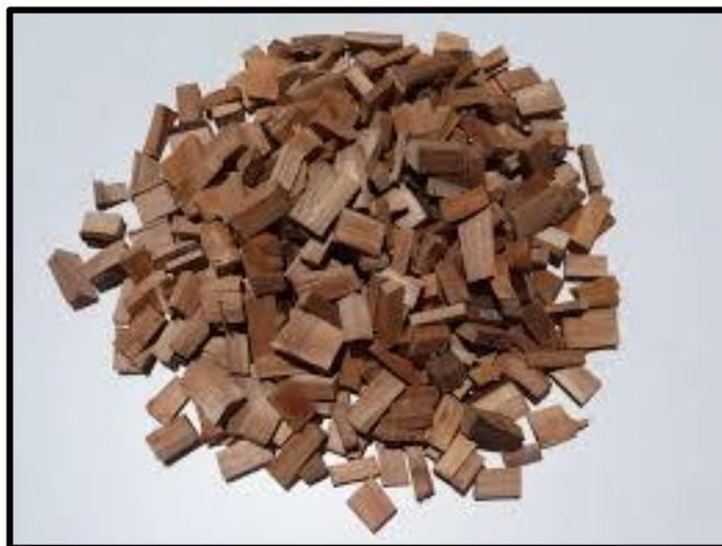
Figura 26 – Chips de madera de residuos voluminosos.
