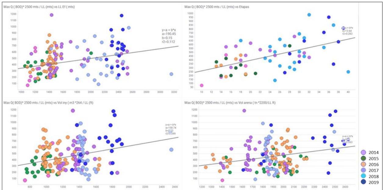
Figura 32. Correlación entre caudal máximo inicial y las variables críticas de diseño normalizadas por la longitud lateral efectiva para 197 pozos en el área LC. (Elaborado con datos de SEE).
