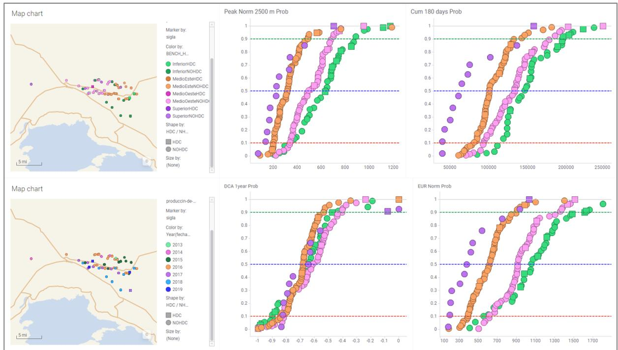
Figura 53. Curvas probabilísticas de las variables productividad incluyendo información de todos los pozos horizontales perforados en objetivos Vaca Muerta en el área LC entre 2012 -2019. (Elaborado con datos de SEE. EUR estimadas con declinaciones generadas para este estudio)
