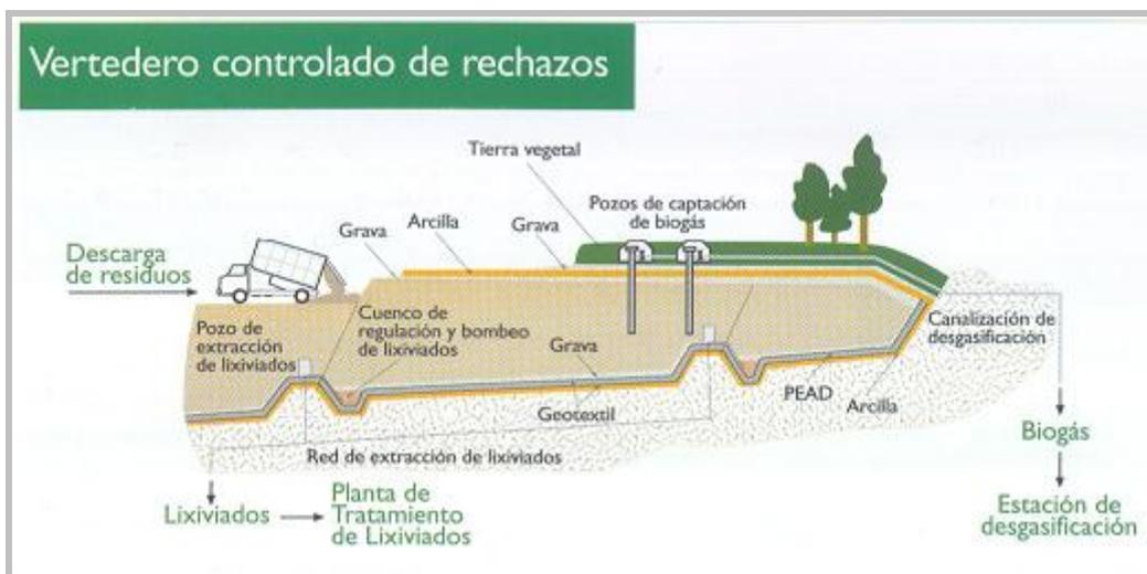
Figura 10.1.5-1: Esquema del relleno controlado de rechazos
