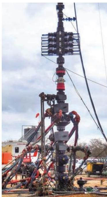
Figura 16. Equipo de presión de unidad de wire line con Quick Latch. (Halliburton tools,2020).
