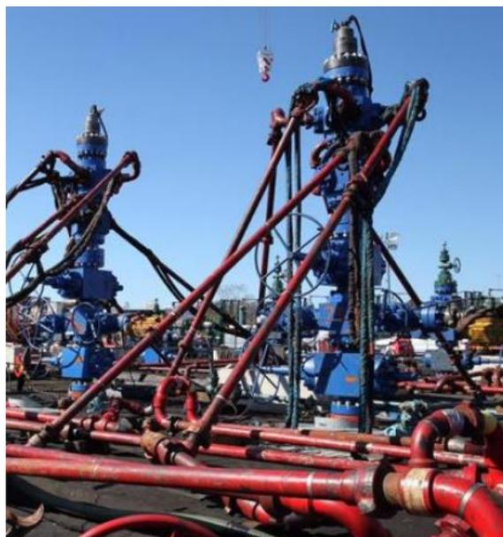
Figura 15. Montaje de set de fractura sin Zipper Manifold y Monoline System.
