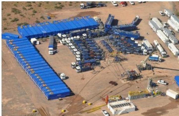
Figura 2. Configuración en L de 50 piletas de fractura.
