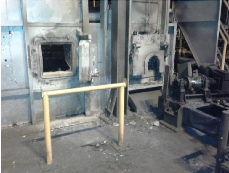
**Figura A1.1** – Exterior del horno: vista de ventana lateral derecha (con su respectiva baranda) y entrada al horno mediante vía de rodillos.
