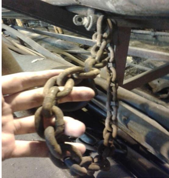
**Figura 1.3 - 8** – Barreta con extremo de cadena utilizada actualmente para extracción de tubo por ventanas laterales.
