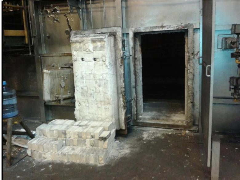
**Figura A1.5** – Puerta de inspección abierta para mantenimiento del horno.
