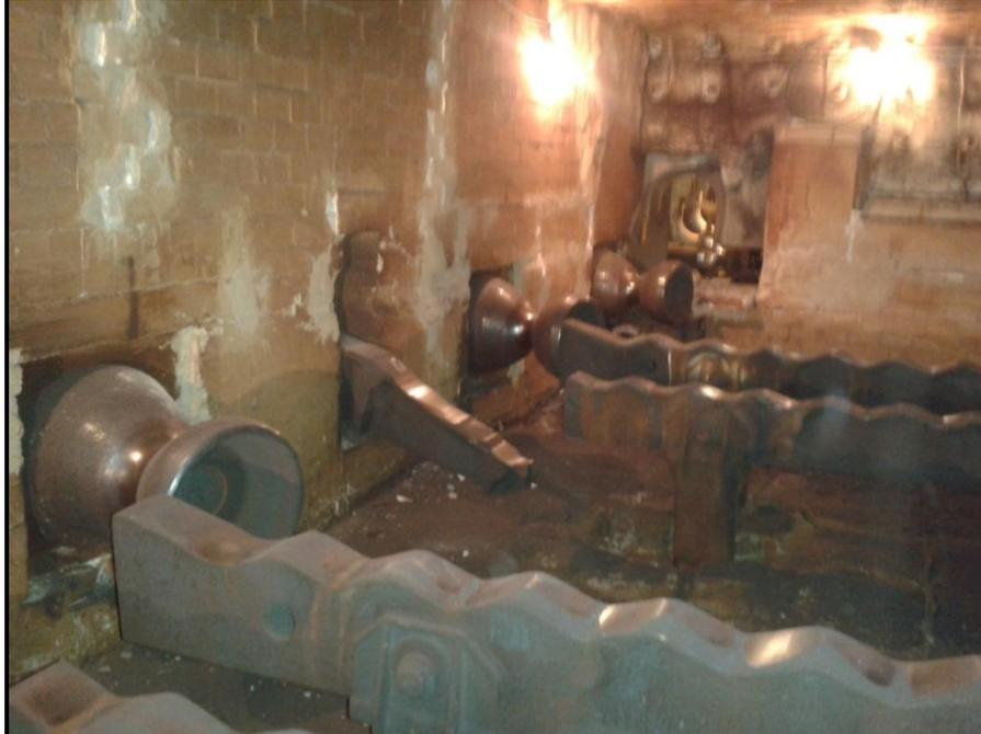
**Figura A1.7** – Vía de rodillos de salida vista dentro del horno. Se puede observar el tope neumático que controla la salida de la carga.
