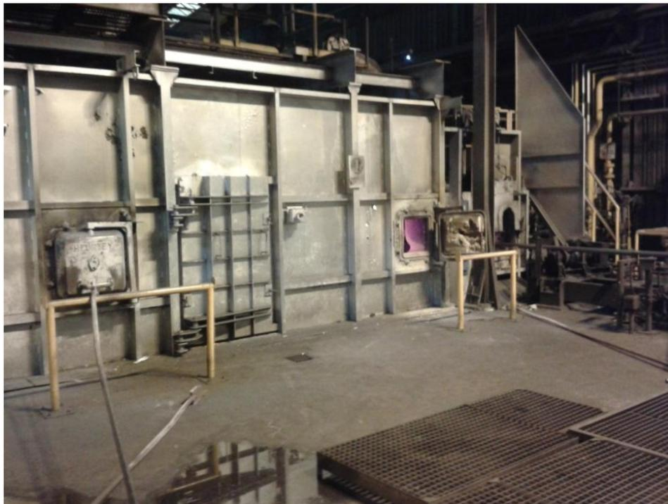
**Figura A1.2** – Exterior del horno: vista de ventanas laterales central y derecha (con sus respectivas barandas); se pueden observar las barretas de uso habitual para conducción de tubos.
