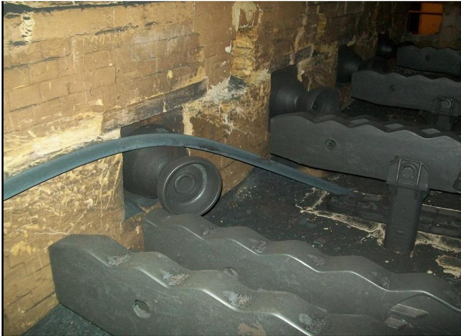
**Figura A1.14** – Tubo torcido impidiendo la salida por la vía de rodillos.
