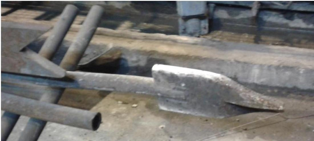
**Figura A1.8** – Extremo de barreta. Una de las geometrías más usadas en la práctica.
