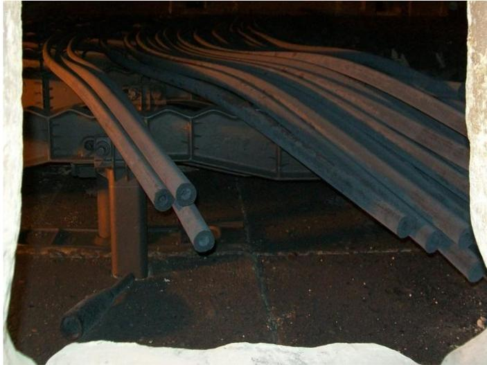
**Figura 1.3 - 7** – Tubos enredados dentro del horno debido al incidente de figura 1.3-6.
