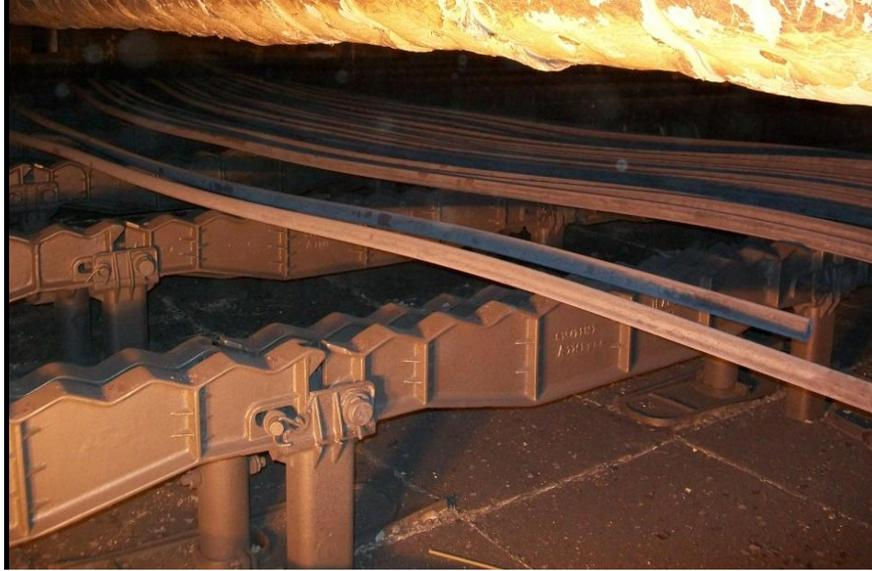
**Figura A1.13** – Tubos torcidos dentro del horno (apagado). Evento de carga amontonada.
