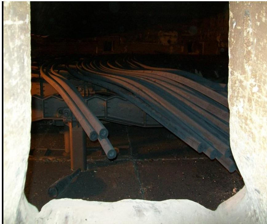
**Figura A1.12** – Tubos enredados como resultado de una carga amontonada de tubos torcidos. El evento
