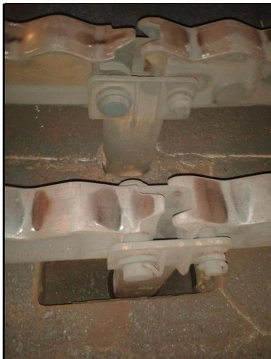
**Figura A1.9** – Detalle de los soportes de barras móviles (primera) y barras fijas (segunda).
