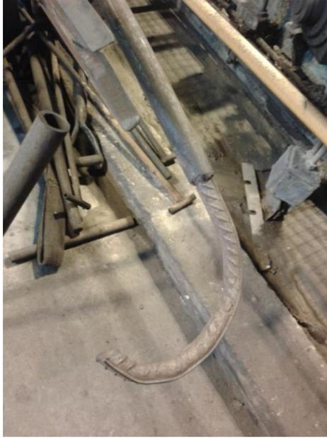
**Figura A1.17** – Barreta con extremo con forma de gancho para guiado.
