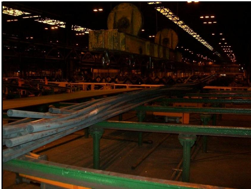
**Figura A1.16** – Tubos torcidos extraídos del horno y ubicados sobre el bancal de entrada.
