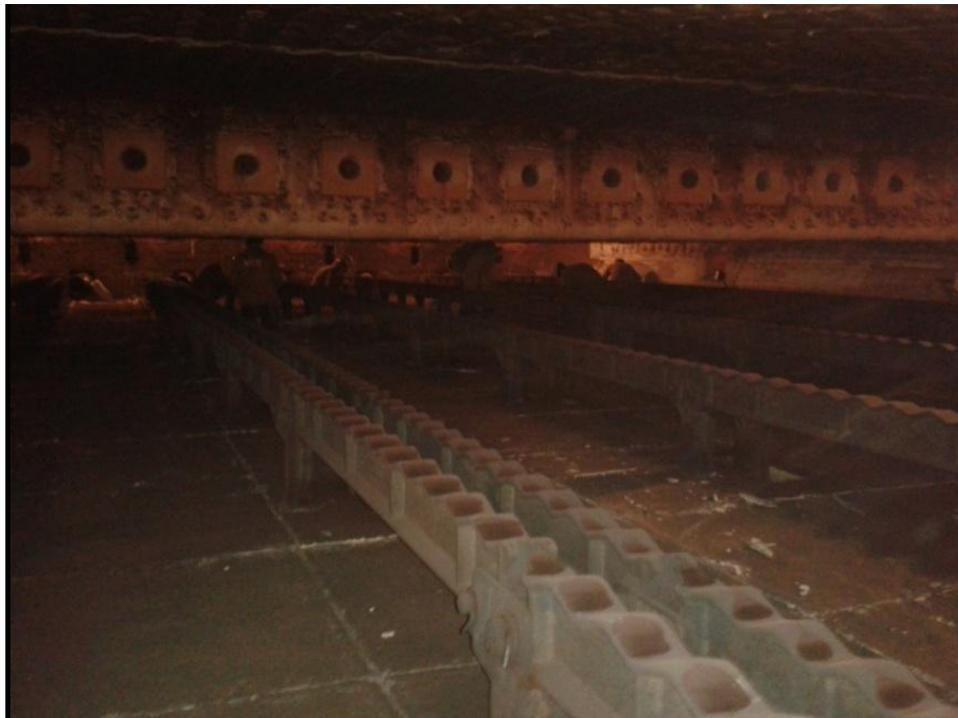
**Figura A1.8** – Interior del horno: se pueden observar los quemadores de la primera cámara en la parte superior.
