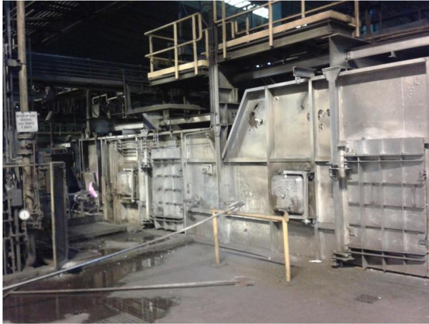
**Figura A1.3** – Exterior del horno: ventanas laterales central e izquierda; en el extremo izquierdo se observa la salida del horno.
