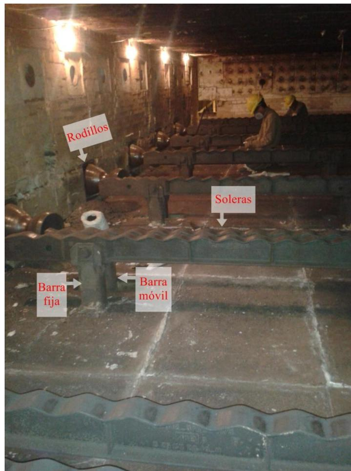
**Figura 1.2 - 1** – Vista interior del horno en período de mantenimiento.
