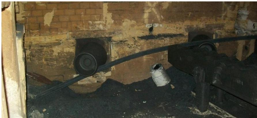
**Figura 1.3 - 6** – Tubo torcido de forma tal que no puede salir por la vía de rodillos. Obliga al apagado del horno para su extracción, donde se toma la figura.
