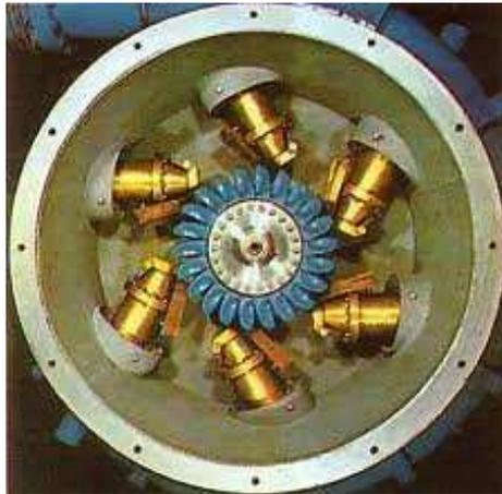
ILUSTRACIÓN IV-8. TURBINA PELTON DE SEIS INYECTORES
