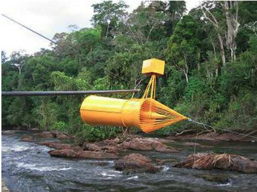
ILUSTRACIÓN IV-1. TURBINA HIDROCINÉTICA
