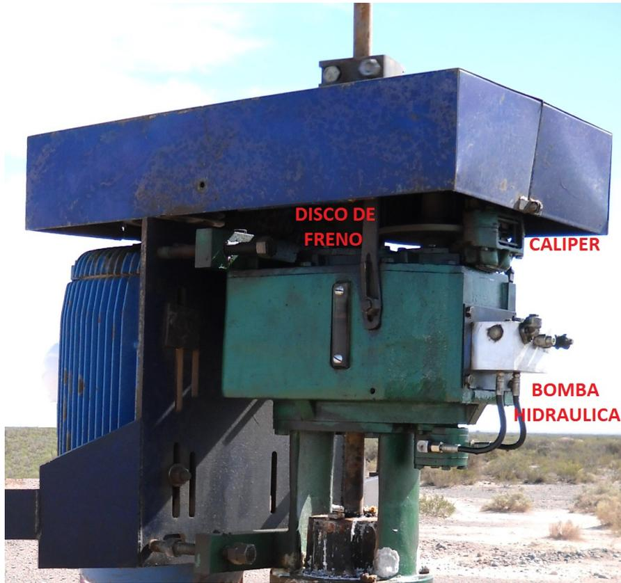
Figura 5: Cabezal con sistema de freno de disco y caliper
