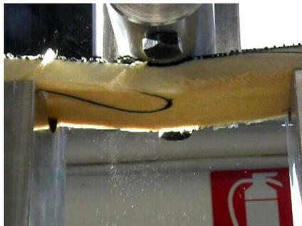
Figura 64 – Estado final de la probeta, rotura por pandeo y delaminación de la lámina de carbono
