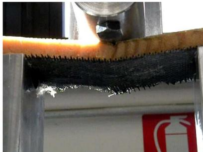
Figura 66 – Estado final de la probeta, rotura por pandeo de la lámina sometida a compresión
