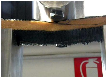
Figura 60 – Probeta luego de la aparición de la rotura (pandeo de la lámina a compresión)
