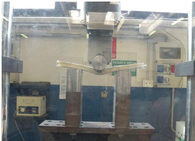
Figura 49 – Dispositivo de ensayo de flexión a tres puntos
