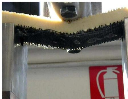
Figura 62 – Probeta luego de la aparición de la falla
