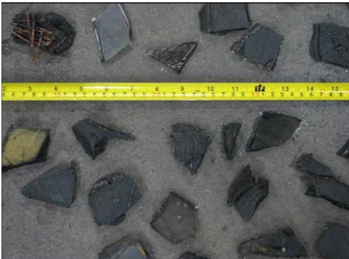
Fig. 5.5: Partículas de 50 mm x 50 mm obtenidas en el proceso de trituración.
