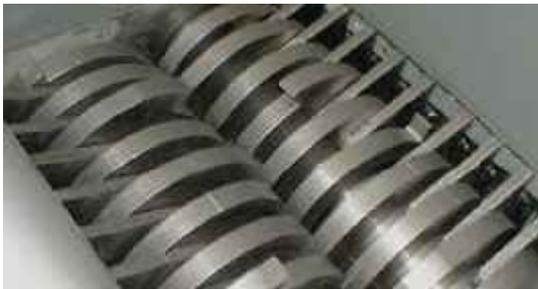
Figura 5.4: Cámara de trituración de un triturador de 2 ejes
