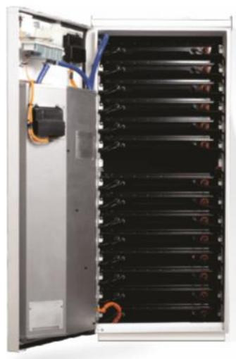
Los “Powerpack” son armarios que integran 16 bandejas individuales de baterías, cada célula tiene su propio sistema de medición de estado de carga, inversor y módulo de medición de temperatura. El armario más sencillo tiene una potencia total 100 kW con 2 horas de autonomía, el más robusto proporciona 500 kW con 4 horas de autonomía. Todo ello es escalable, con lo que conectando varios armarios de este tipo entre sí se puede añadir más potencia o capacidad al sistema.
