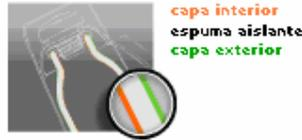
Figura 5.5– Aislamiento térmico de un recipiente mediante espumas
