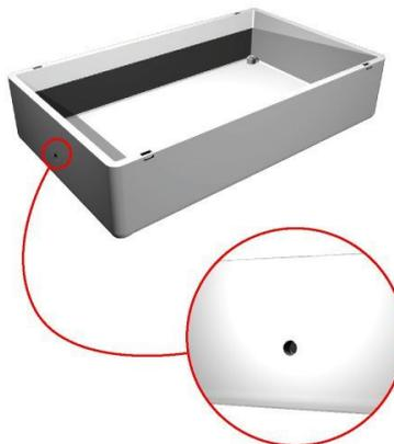
Figura 9.33 – Orificio frontal de la carcasa inferior para el sistema calentador
