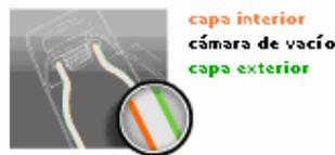
Figura 5.2 – Aislamiento térmico de un recipiente mediante vacío
