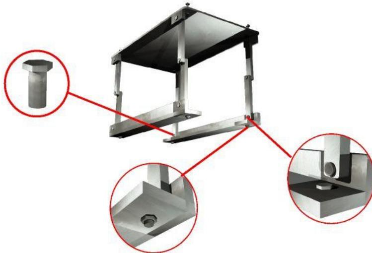
Figura 9.77 – Interfase de la base con el vehículo
