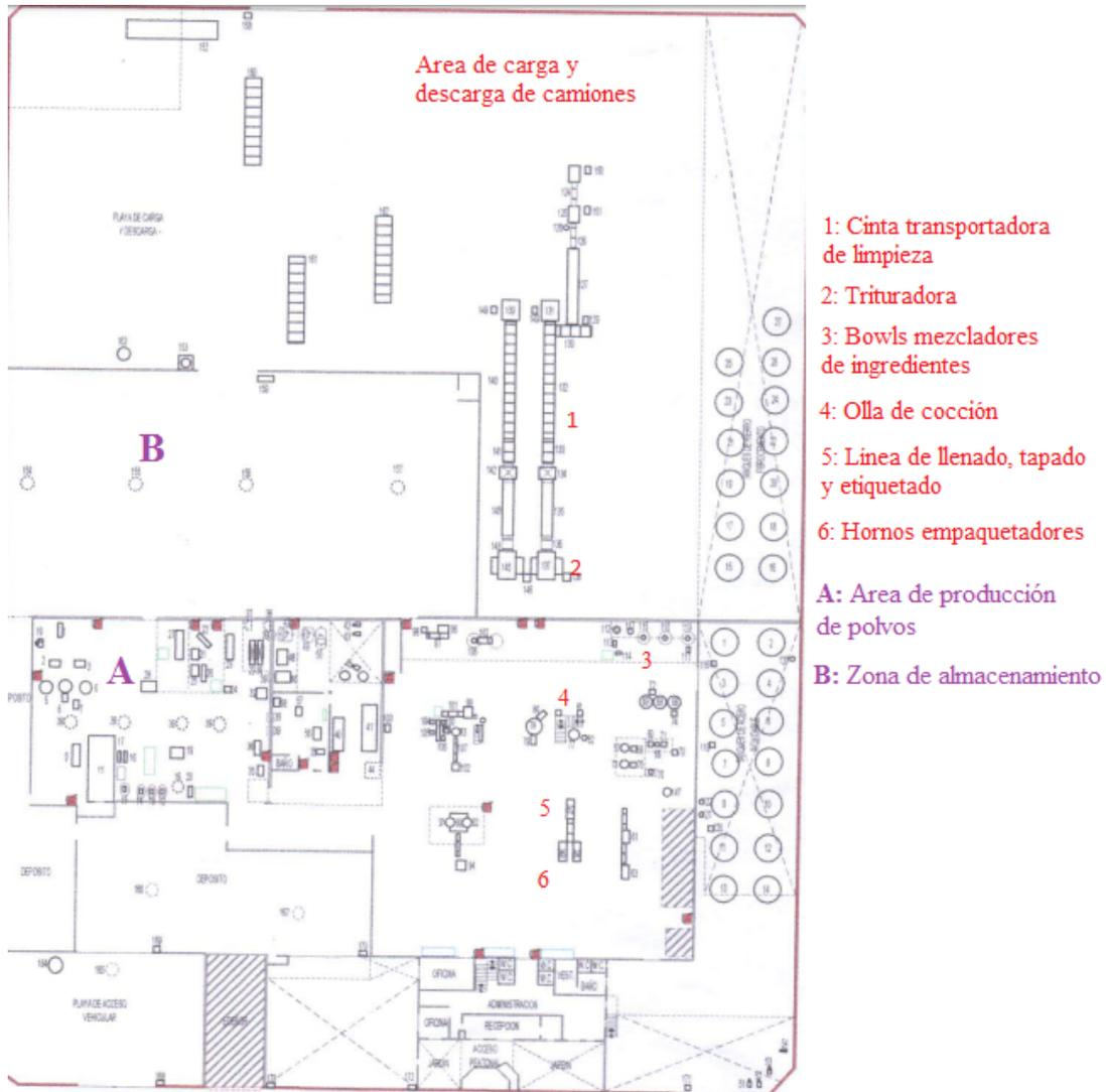
Figura 3.32: Lay Out de la empresa Dulfix
