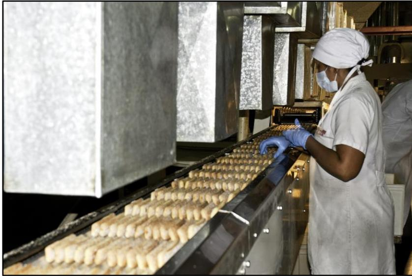
*Figura 43: Transportadora de enfriamiento. Fuente: Elaboración propia*
