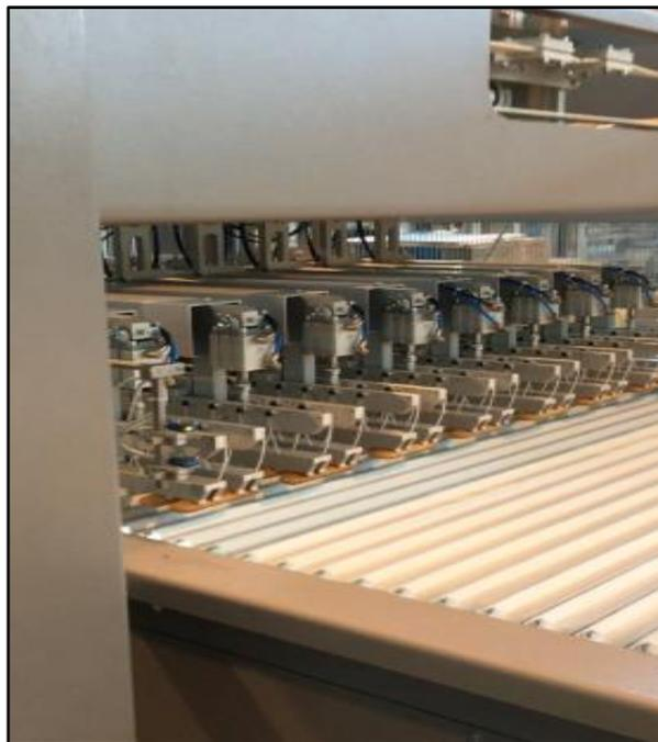
*Figura 60: Depanner de agujas (también se puede usar con mecanismo de presión de vacío). Fuente: Tecnopack*
