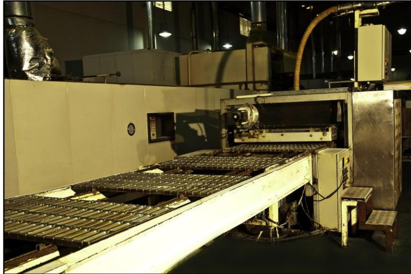
*Figura 35: Depositadora. Fuente: Elaboración propia*
