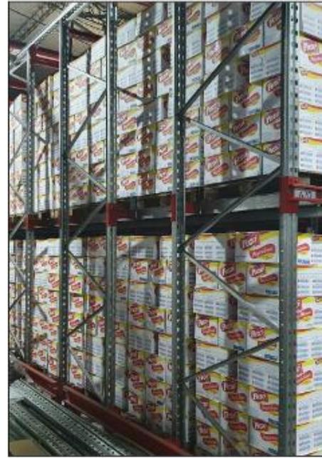
Figura 98: Rack penetrable de producto terminado. Fuente: Elaboración propia
