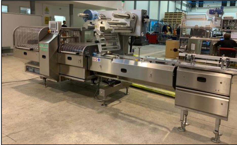
Figura 57: Flowpack 1, envasado de paquete primario. Fuente: Web de Tecnopack.
