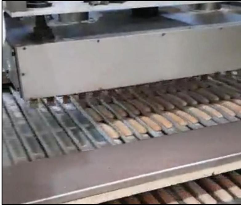
Figura 41: Vainillas siendo posicionadas en taparela. Fuente: Elaboración propia
