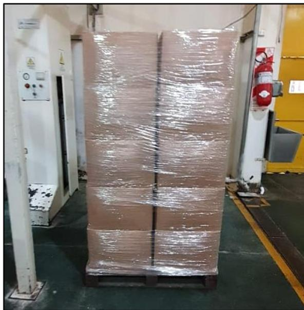
*Figura 109: Pallets envueltos en stretch. Fuente: Elaboración propia*
