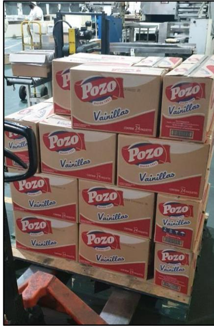
*Figura 48: Armado de pallet de vainillas en una zorra neumática. (60 cajas por pallet).
