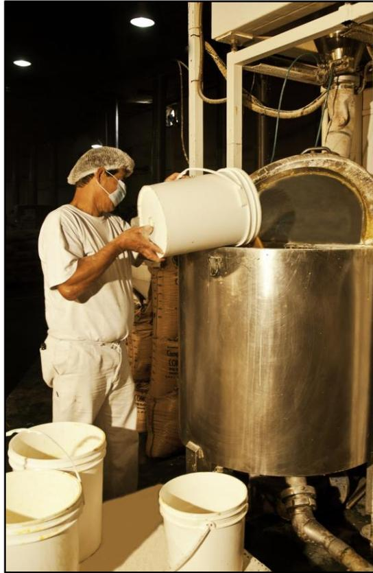
*Figura 32: Estación de batido de la mezcla para vainillas. Fuente: Elaboración propia*
