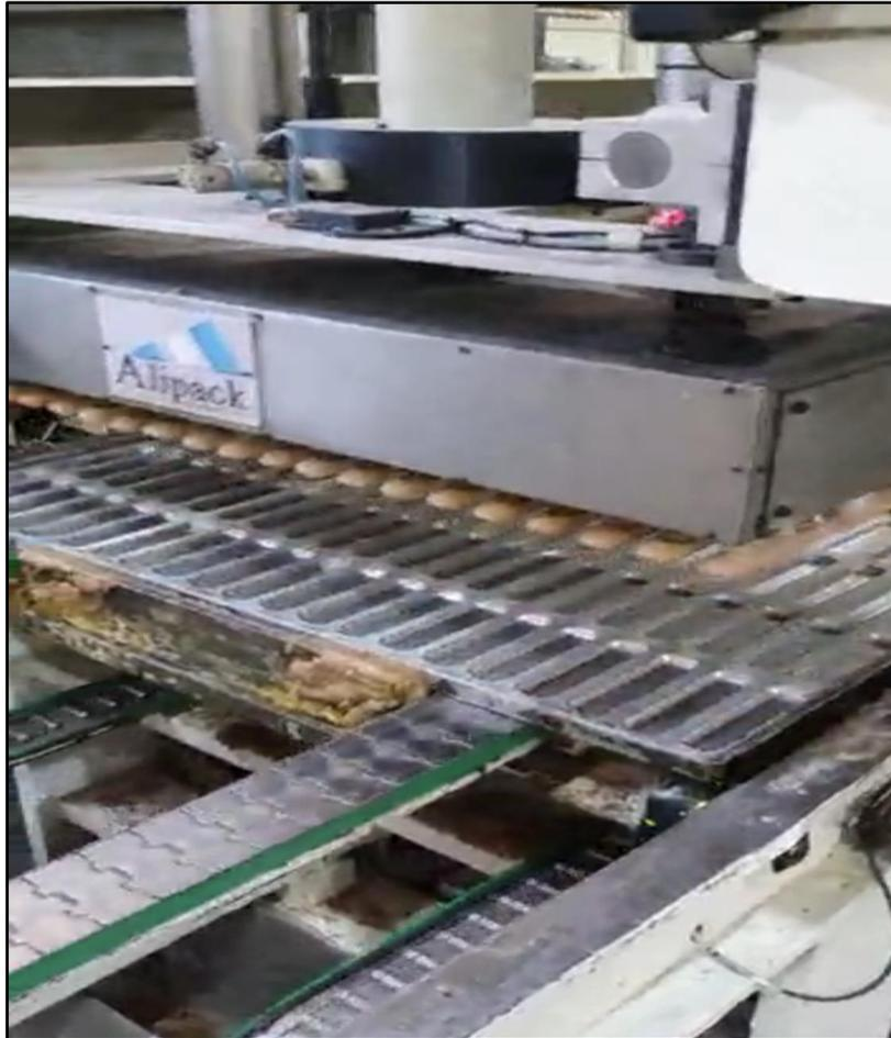
*Figura 40: Vainillas siendo removidas de la bandeja con el depanner. Fuente: Elaboración propia*
