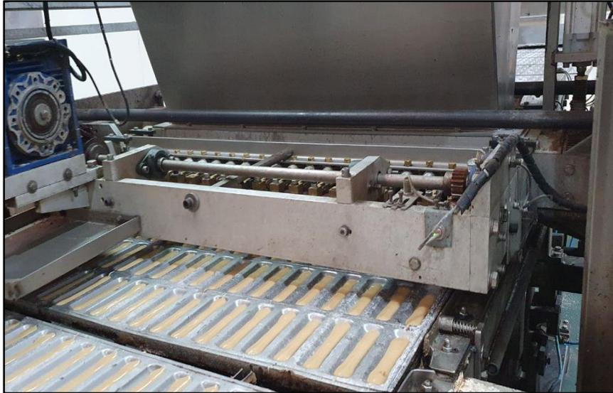
Figura 63: Ejemplo de depositadora volumétrica. Fuente: Productos Pozo.
