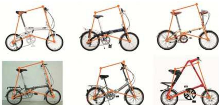
*Figura 3.2 – Se reconoce una distribución ergonómica común en el total de los modelos presentes en el mercado. En base a esta disposición se trazan las reglas que debe seguir el proyectista.*
