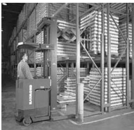
**Figura III.III.9.** Reach truck Doble Profundidad
