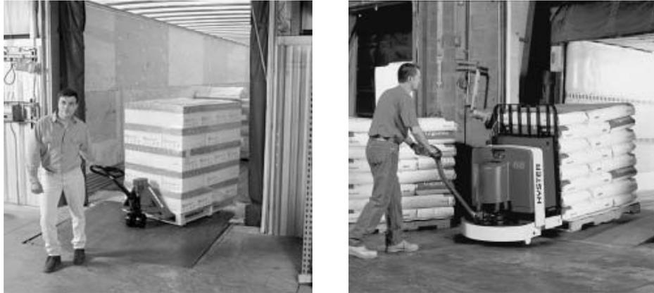
**Figura III.III.5.** Transpaleta hidráulica y transpaleta eléctrica, de izquierda a derecha
