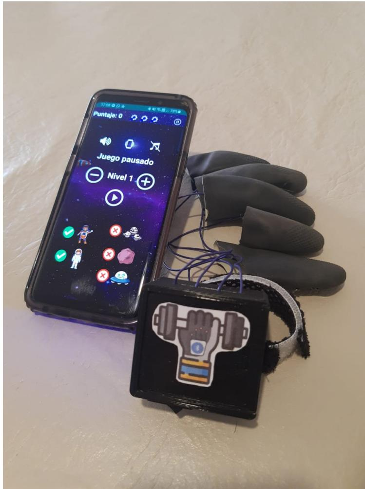
Figura 24: Imagen de la interfaz de control junto a la aplicación en un celular Samsung S9, en el menú de pausa del juego del espacio.
