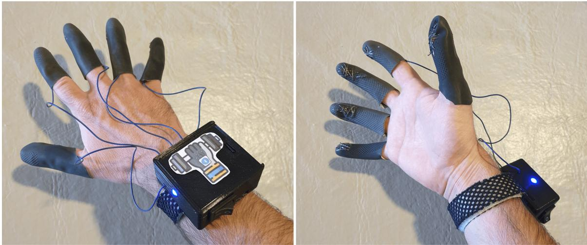
Figura 22: Diferentes vistas de la interfaz colocada en el brazo y los sensores sobre los dedos.
