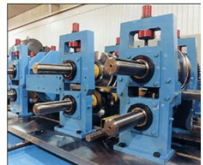
Figura 4.4.1-2: Rodillos conformador
