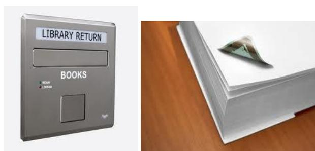
Ilustración 36: Sistema RFID de devolución de libros. Libro con RFID tag
