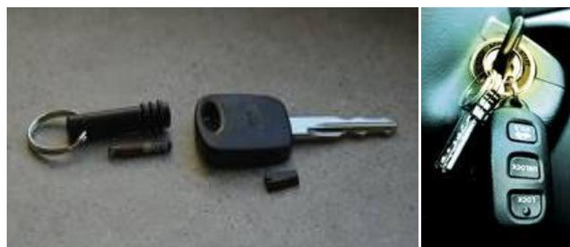
Ilustración 34: Llaves con dispositivos RFID anti robo
