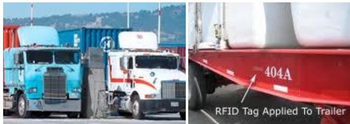
Ilustración 39: Camiones y remolques con sistemas RFID
