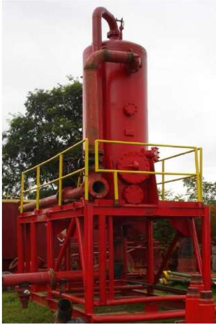
*Fig.21– Separador bifásico*
