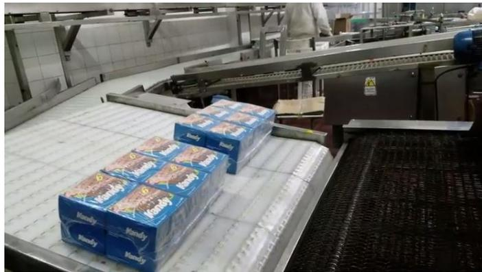
*Imagen A.5 Pack 6 empaques a la salida de colocación de termocontraíble*
