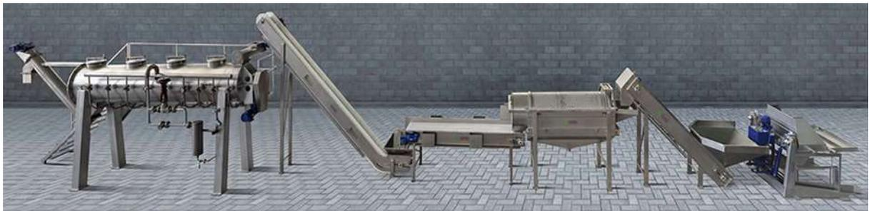
Figura 2.14: Línea de extracción de pulpas de ciruela
