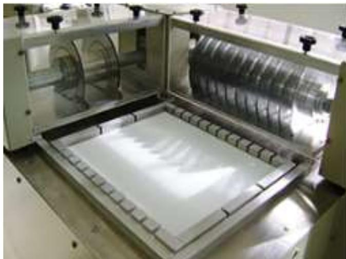
Figura 2.6<sup>65</sup>: Cortadora de barras.
