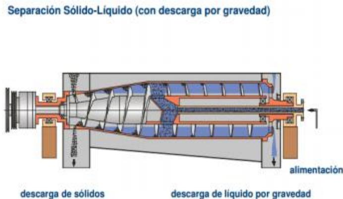
*Fig.64 : esquema de un centrifugador.*
