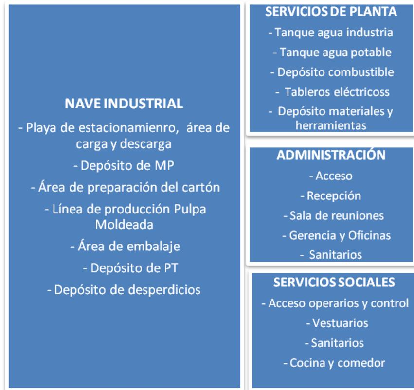
Diagrama 2-4.5. Esquema de la planta industrial.
