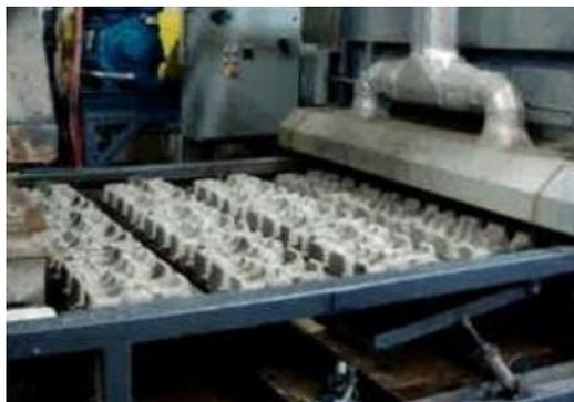
Imagen 11-4.3. Bandejas de pulpa moldeada ingresando al horno de secado.
