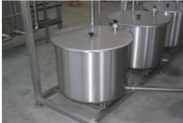
Figura III-6. Baldes que recogen la yema, albúmina o huevo entero desde las bandejas de la quebradora.
