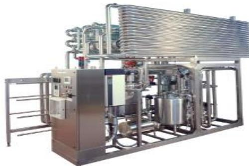
Figura III-10. Pasteurizador.
