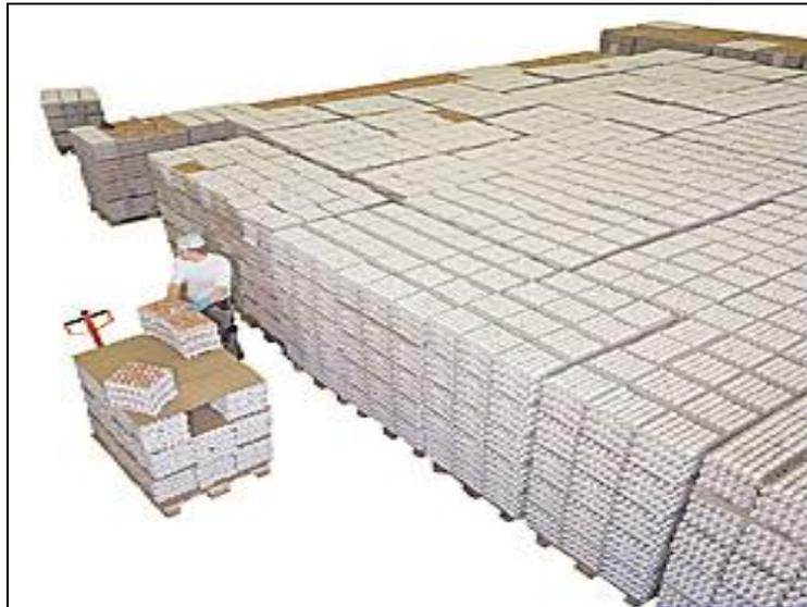
Figura III-2- Fotografía del depósito de materia prima. Almacén a nivel de piso para evitar la rotura del huevo con cáscara.
