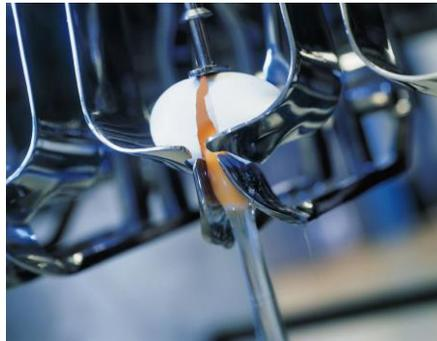
Figura III-5. Sistema de quebrado. La albúmina cae a una bandeja inferior mientras que la yema se deposita luego en otra bandeja.
