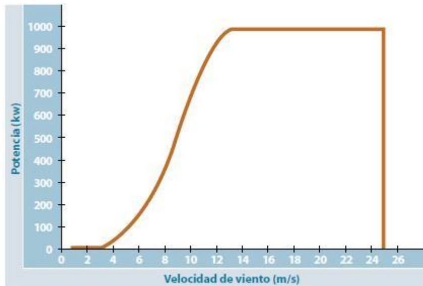
La forma de obtener el factor de capacidad FC para cierta región, es a través de la integración matemática entre la distribución de probabilidad (obtenida de acuerdo a las mediciones en el campo) y la función matemática que describe la curva de potencia de la máquina, facilitada por el fabricante.
