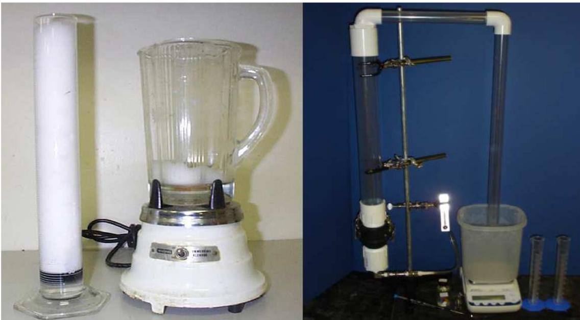
La imagen de la izquierda nos refiere al *procedimiento del test de la licuadora* que consiste en tomar 100 ml de agua de formación, hidrocarburo líquido y agente espumante mezclados en una licuadora a alta velocidad por aproximadamente 20 segundos. La espuma producida es
