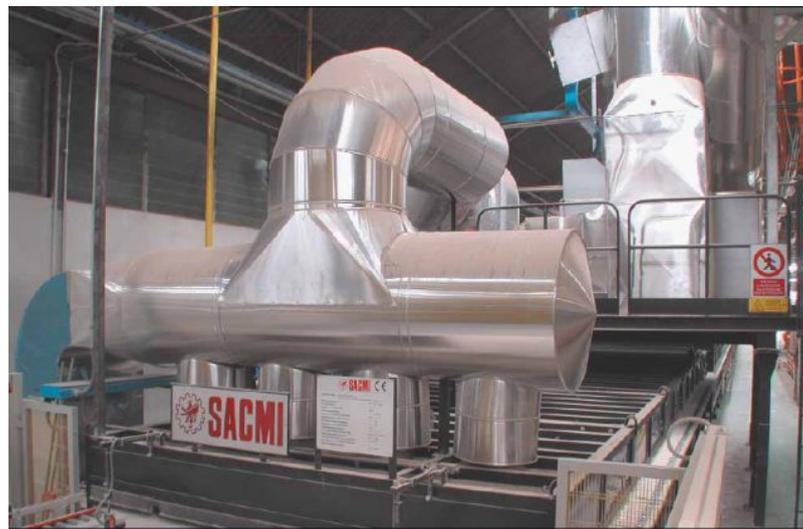
Imagen 2.6-Tubos de Extracción Ubicados a la Salida del Horno<sup>33</sup>
