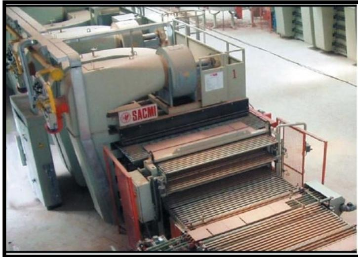
Imagen 2.3-Secadero Horizontal de Tres Pisos<sup>29</sup>
