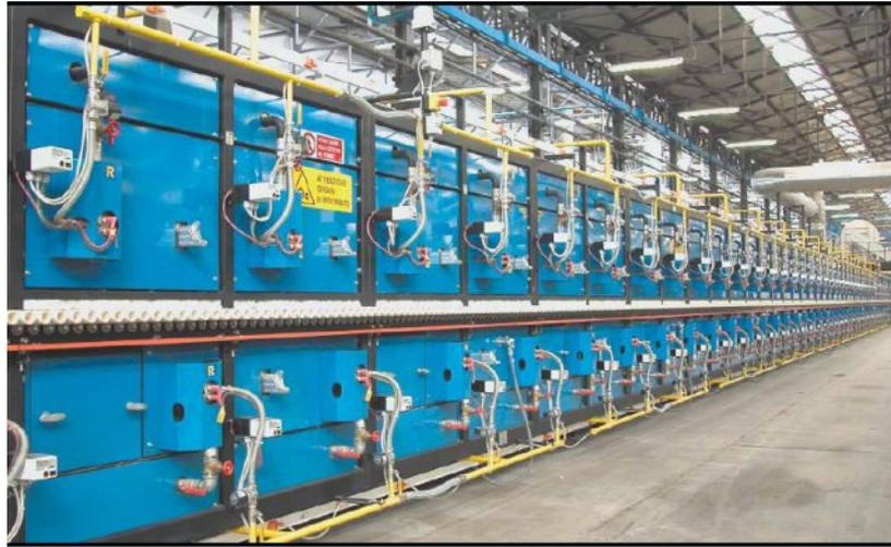
Imagen 2.5-Vista Lateral de un Horno de Cocción de Cerámica Monoporosa<sup>32</sup>
