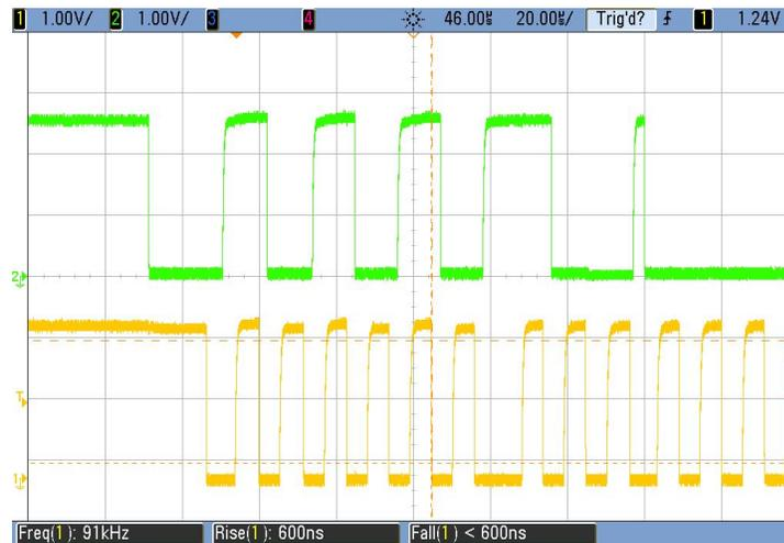
Fig. 26. Medición de SDA (verde) y SCL (amarillo) para conocer el estado de carga de la batería.
