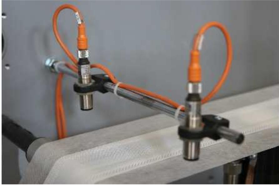
**Figura 2-17 - Ejemplo de Sensores para Controlar la posición del Producto dentro de la Máquina**
