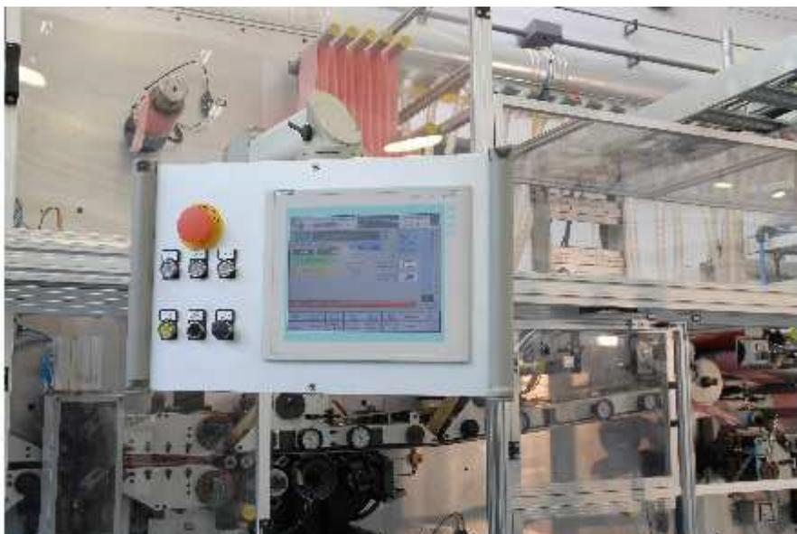
Figura 2-16 - Panel Touch Screen para Manejo de la Máquina
