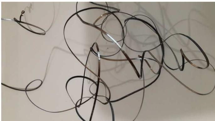
Figura 17: Tipo de viruta obtenido para el material Q1225 a  $v = 250$  m/min
