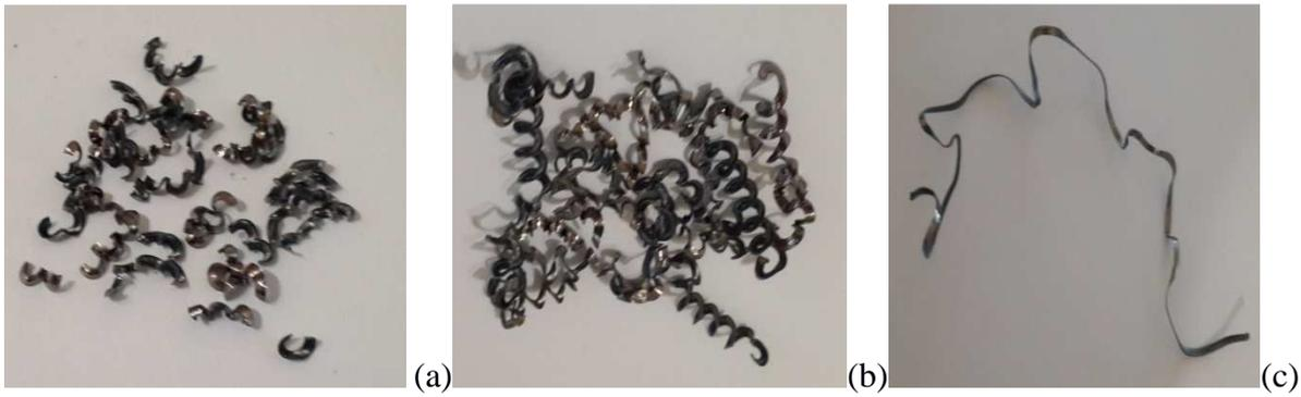
Figura 15: Tipos de Viruta obtenida para Q125 a  $V=230$  m/min: (a) para  $T = 1$  min (b) para  $T = 3$  min (c) para  $T = 7$  min
