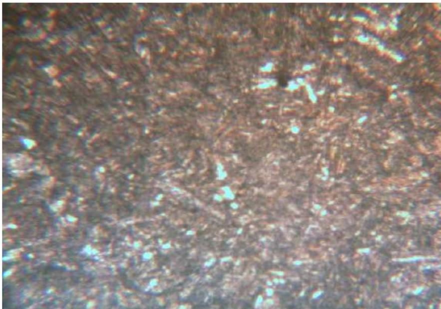
Figura 4: Metalografía del material Q125; 400X
