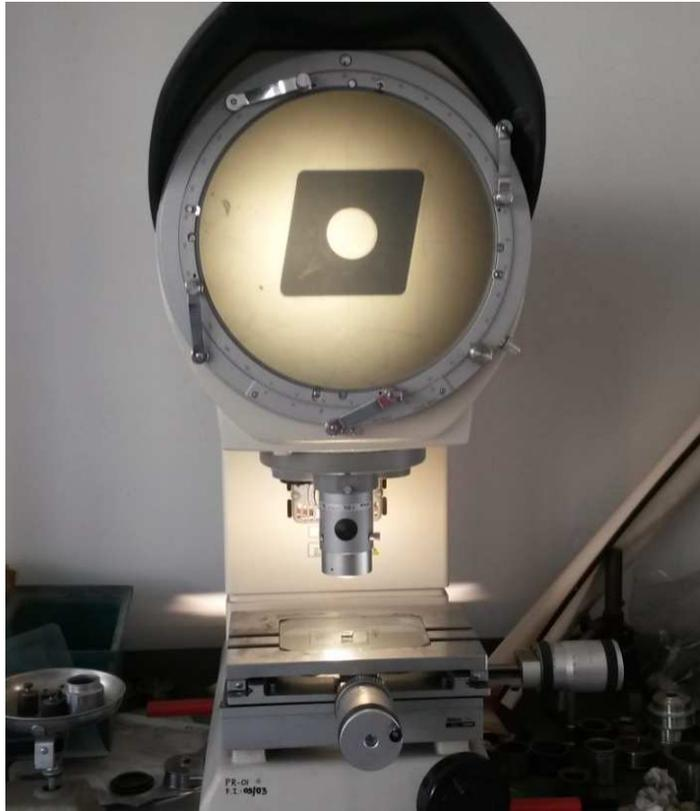
Figura 18: Perfilómetro de proyección Nikon V12-A
