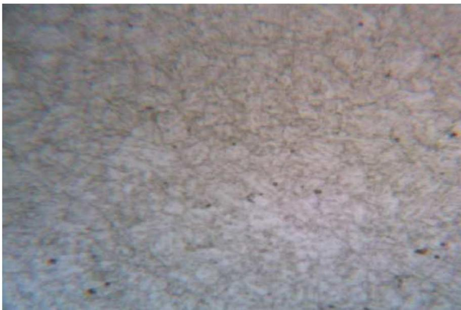
Figura 8: Metalografía del material TN803CR; 400X
