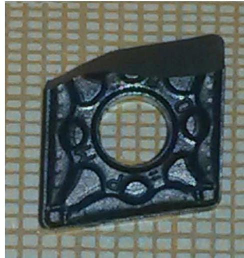
Figura 13: Rotura prematura de inserto de corte
