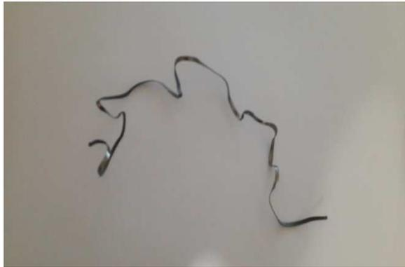
Figura 12: Viruta continua producto de profundidad de corte excesiva
