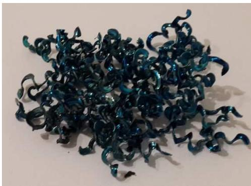
Figura 16: Tipo de viruta obtenido para el material TN803CR a  $v = 450$  m/min
