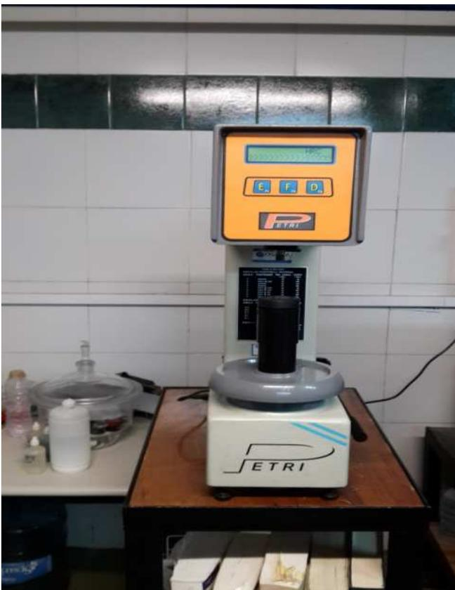
Figura 33: Durómetro digital modelo F-26
