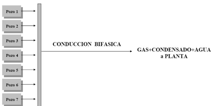
Los equipos principales en la batería son el *manifold*, que es una unidad paquetizada que posee las facilidades necesarias para enviar el fluido de diferentes pozos a producción y/o control.
