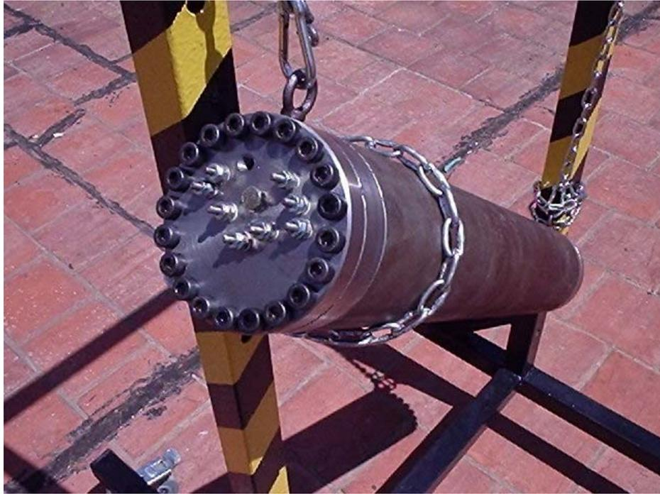
Figura C2. Prototipo electrolizador de alta presión.
