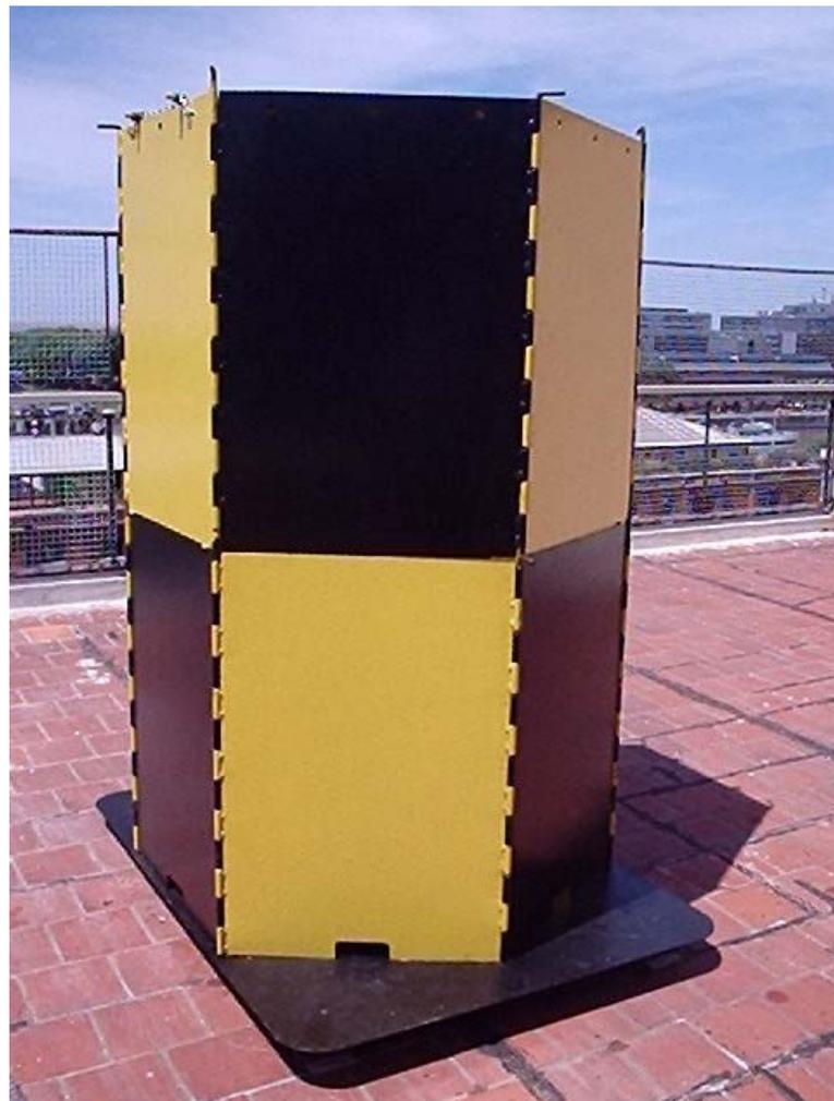
Figura C3. Cabina de seguridad para el electrolizador.
