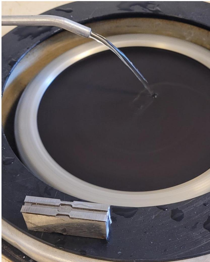
Figura 51: Sistema de pulido de las probetas chicas
