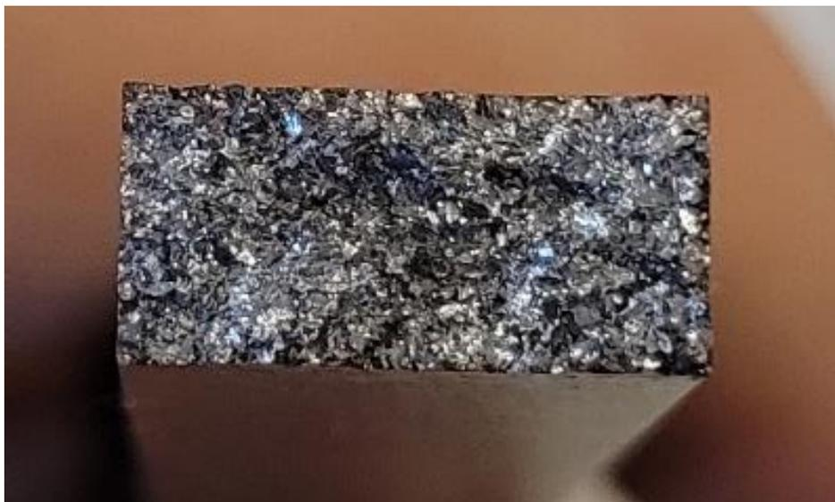
*Figura 58: Rotura de una probeta grande*
