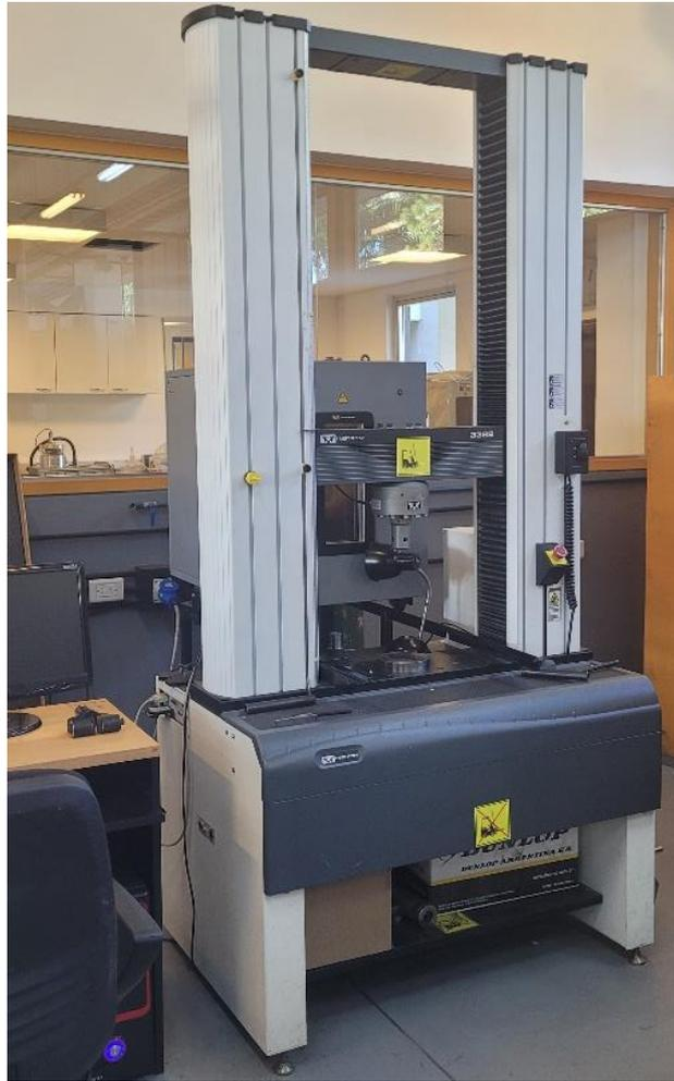
Figura 19: Máquina de tracción del ITBA
