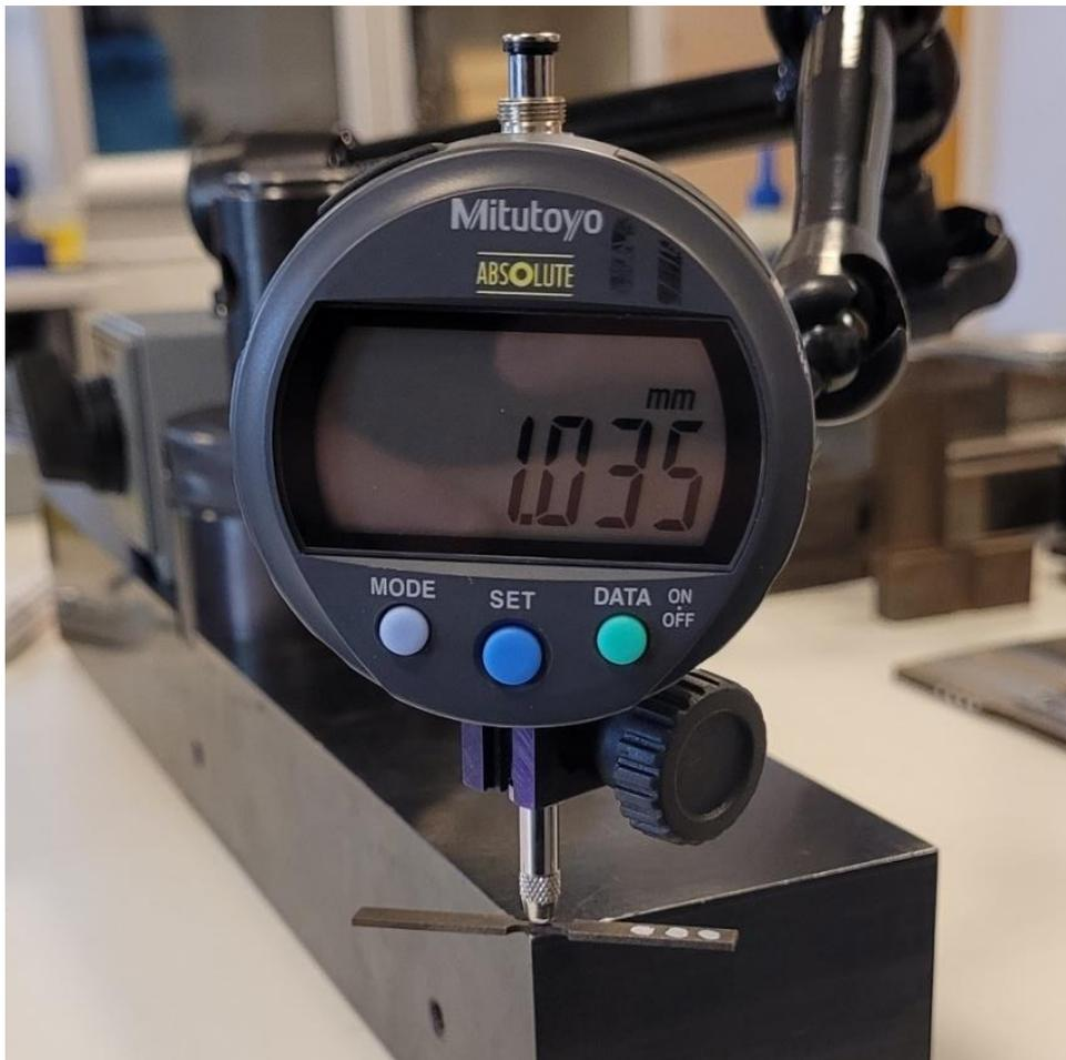
*Figura 55: Sistema de medición de las probetas pequeñas*
