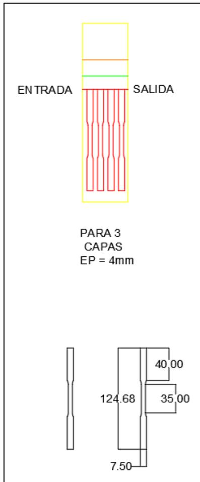
Figura 26: Probetas medianas
