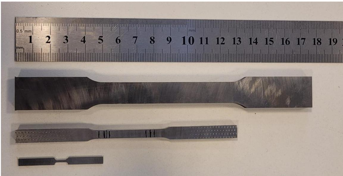
Figura 72: Comparación de los tamaños de probetas
