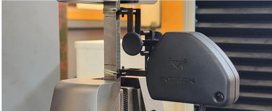
Figura 54: Extensómetro INSTRON 50mm
