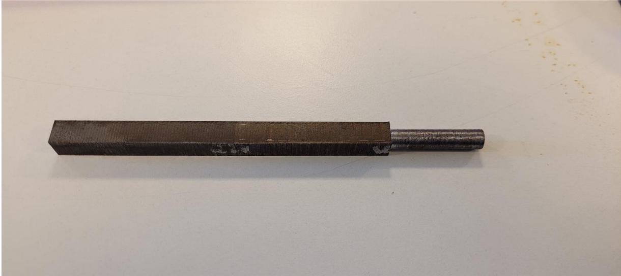
*Figura 42: Inicio de la mecanización de las probetas cilíndricas medianas*
