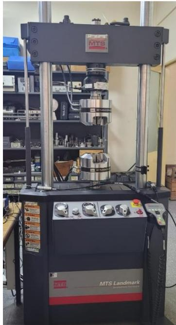
Figura 20: Máquina de tracción del CNEA
