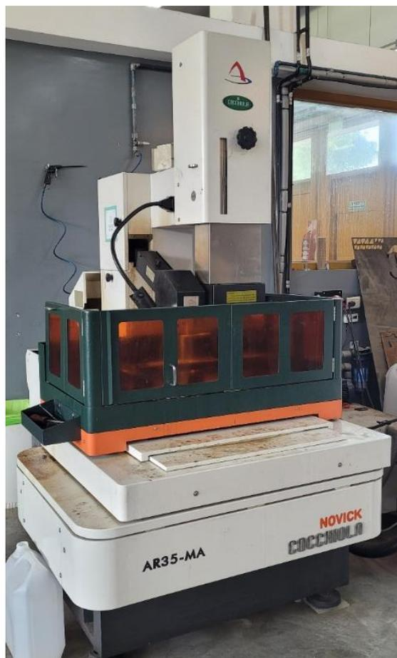
Figura 18: Máquina de corte por hilo del ITBA
