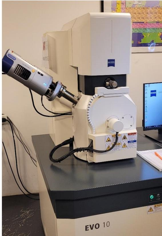
Figura 61: Microscopio electrónico de barrido
