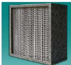
Este es el filtro absoluto de pliegue profundo. Está fabricado con marco metálico de chapa galvanizada de 1,25 mm de espesor que ofrece máxima protección al medio filtrante, resistencia a la corrosión y estabilidad dimensional. El medio filtrante es de microfibras de vidrio extrafina resistente a la humedad (100 %) y está encapsulado en su totalidad para asegurar la ausencia de fugas.
