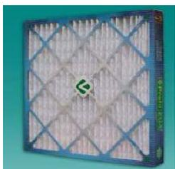
Estos prefiltros poseen un medio filtrante no tejido, compuesto por fibras de algodón reforzadas con fibras sintéticas. El soporte metálico es de aluminio adherido totalmente al medio filtrante. El marco perimetral es de cartulina doble de alta resistencia, con refuerzos diagonales en ambas caras. En función de la caída de presión se puede determinar fácilmente cuando el prefiltro debe ser
