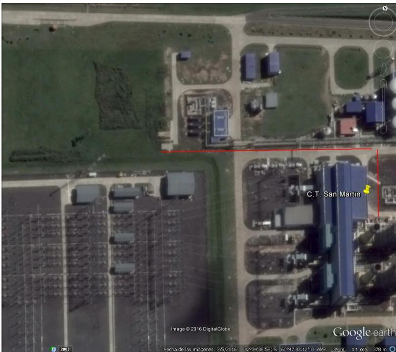
Figura 117 - Traza del gasoducto (CO<sub>2</sub>) desde central térmica a planta de biodiesel – Fuente: (100)
