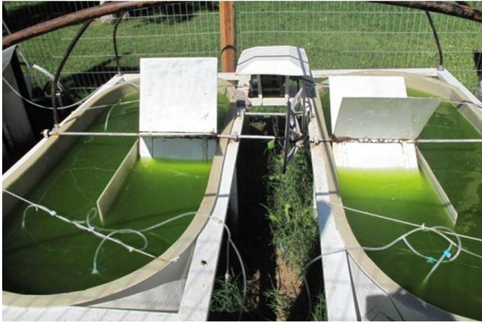
Figura 111: Sistema de cultivo tipo hipódromo (Raceway ponds) a pequeña escala. Fuente: (149)
