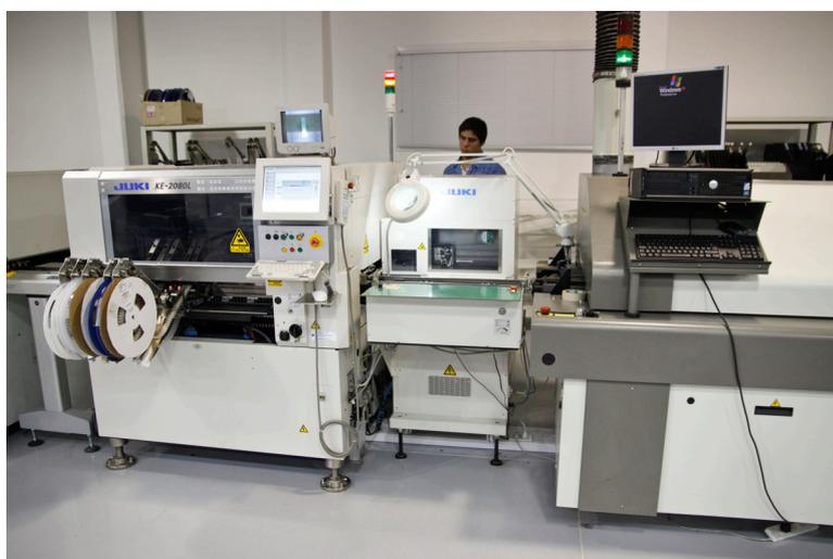
Ilustración 6 Máquina de Inserción Automática.
