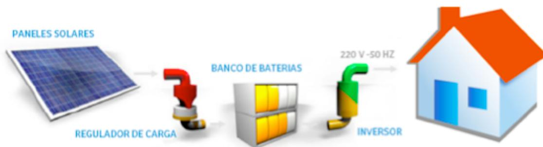
Figura 13: Funcionamiento básico de un sistema FV. Fuente: Elaboración propia
