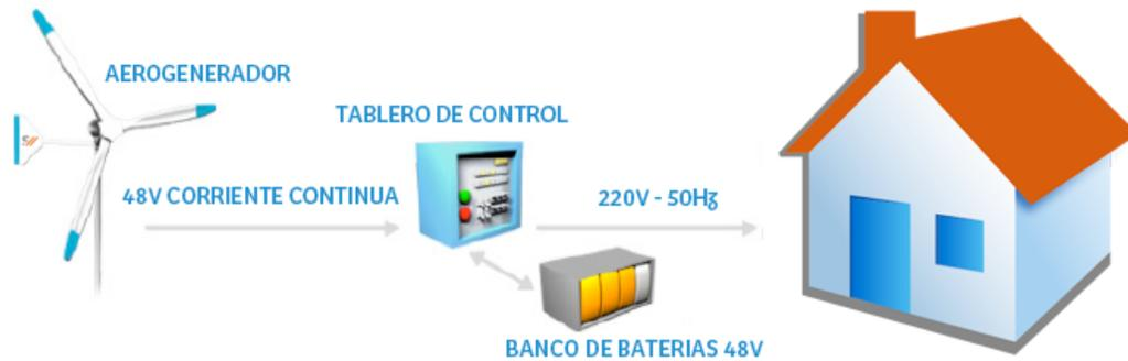
Figura 8: Funcionamiento básico de un sistema eólico. Fuente: Elaboración propia
