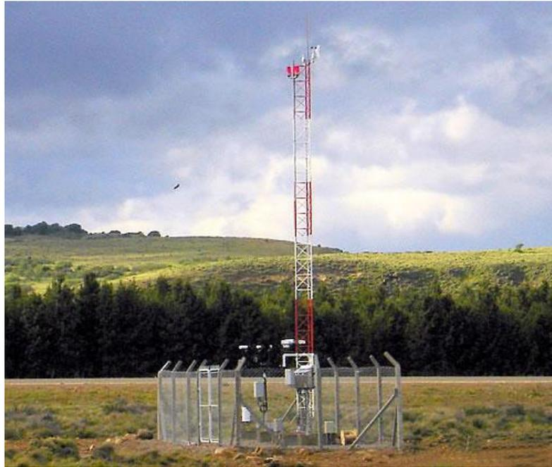
Figura 4.1 Foto: Estación de Observación Automática de Meteorología (AWOS)
