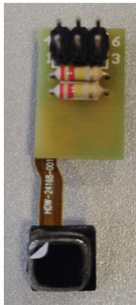
(a) Placa de sensor con trackpad desconectado.
