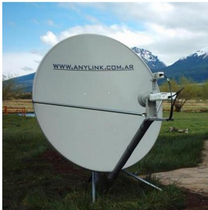
*Figura 5.1.3.1. Ejemplo de estación VSAT*
